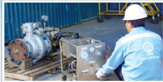
Thử nghiệm khả năng chịu áp lực, thử kín các loại thiết bị chịu áp lực như nồi hơi, hệ thống lạnh, đường ống, bình chịu áp lực,... trong tất cả các lĩnh vực, không giới hạn mức áp suất.
